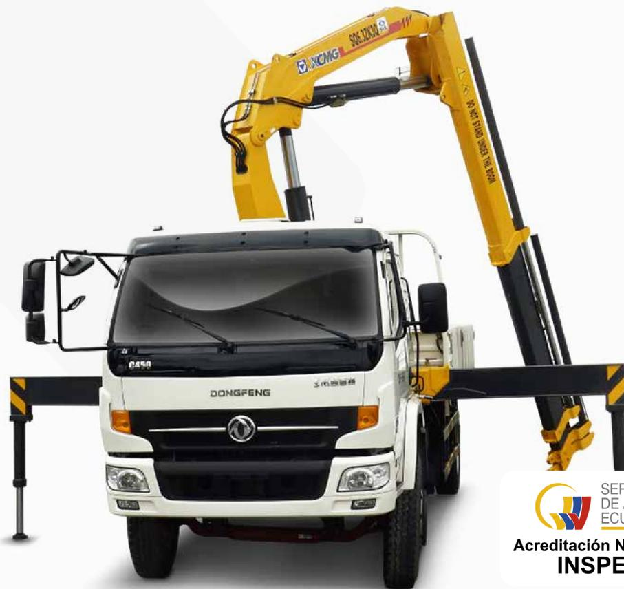
*Es un equipo compuesto por una columna que gira sobre una base, y un sistema de brazos sujeto a la parte superior de la columna.*
